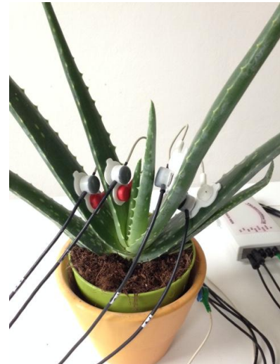
Obrázek 10: rostlina Aloe vera s aplikovanými elektrodami
